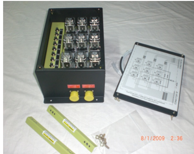
Vista caja de fusibles y relays sectorizados.
