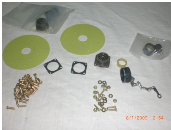
Kit instalación conector en zona presurizada.
