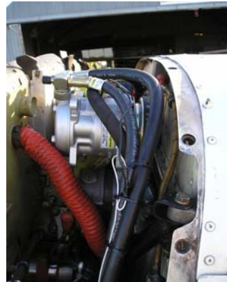
Instalación Compresor A/C
